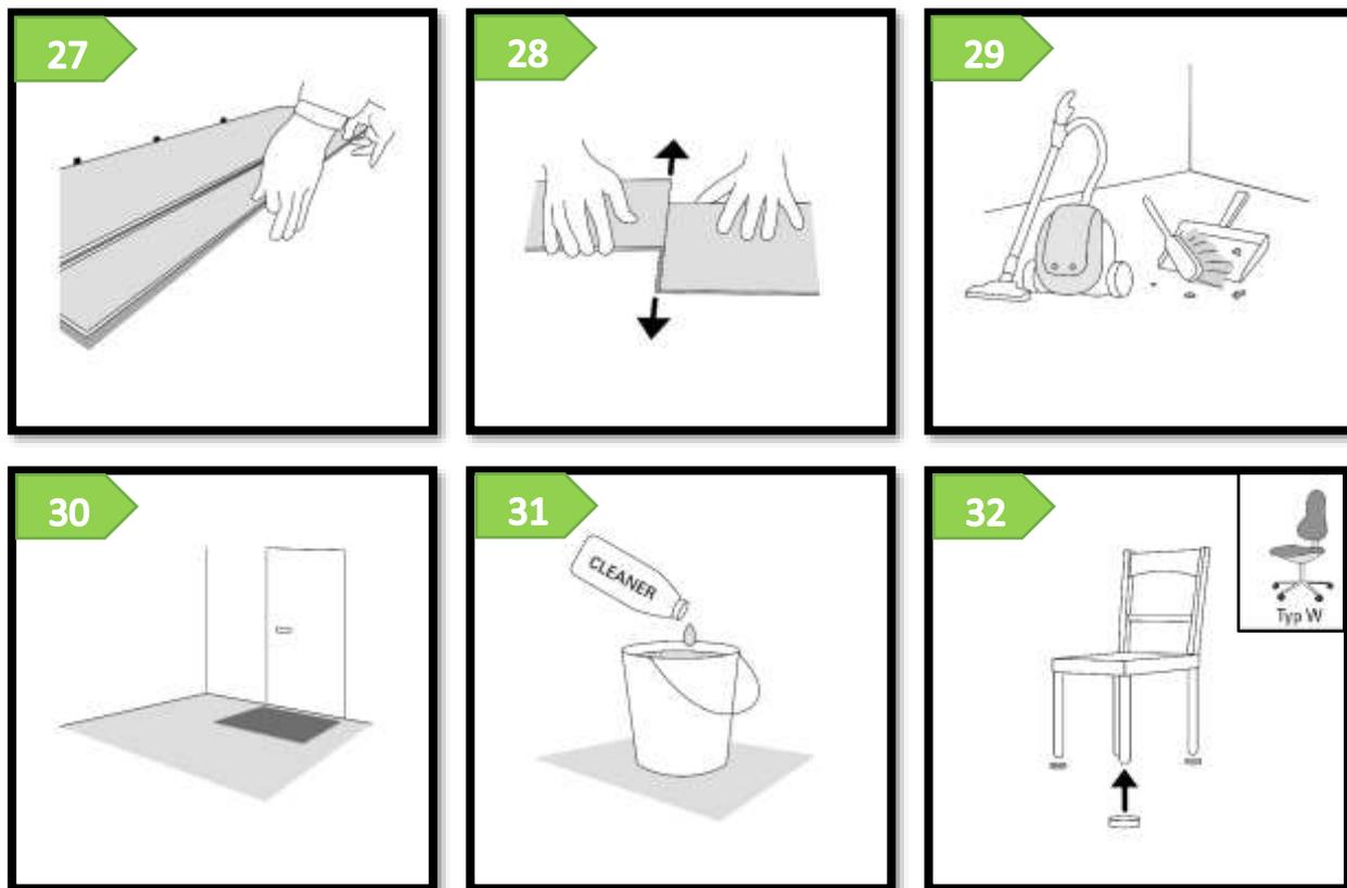
Zur Verlegung der letzten Reihe wird der Abstand zwischen der Wand und der verlegten Reihe gemessen und auf das Paneel übertragen. Die letzte Verlegereihe sollte möglichst einer halben Paneelbreite entsprechen. Denken Sie an die 5mm breite Bewegungsfuge.
