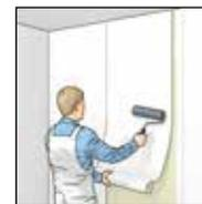
**8.** ERFURT-KlimaTec KV 600 ist nach Trocknung überzutapezieren. Dabei durch seitlichen Versatz der Stoßnähte eine Naht-auf-Naht-Verklebung vermeiden.
